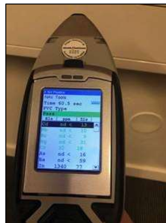
Veggkanaler i plast i KA23 og XRF-måling. Foto: Jennifer Lamson
